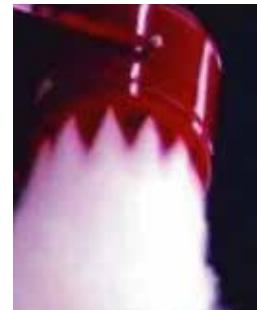
AYG Aerosol üreteçleri son derece etkili bir sabit söndürme sisteminin bir parçası olarak kullanılabilir. Bu söndürücüler basıncı değil ve koruma gerektiren bir oda ya da bölmenin içine monte edilir. Aktivasyon sonrasında, bir aerosol bulutu şeklinde ortama püskürerek, hacimsel yoğunluk oluşturulur. AYG söndürücüler çoğunlukla normal ve boş alanlarda kullanmak üzere tasarlanmıştır. **A, B, C sınıfı** yangınlarda etkilidir.
